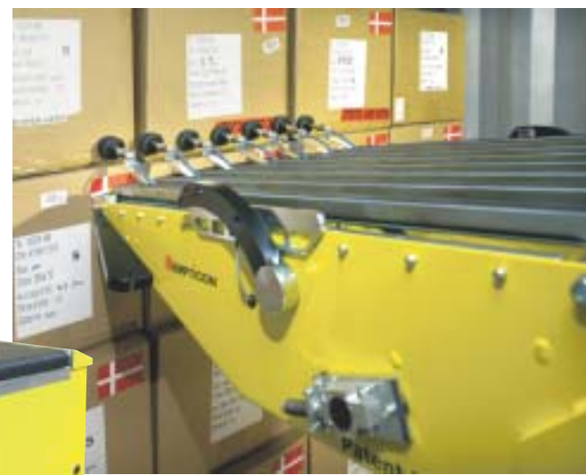
Empticon styres nemt og ergonomisk korrekt af én enkelt operatør. Maskinen betjenes fra en bærbar styrepult, hvor operatøren manøvrerer via joystick. Derved undgås de mange høje, lave, skæve og tunge løft, som kendetegner arbejdet med containertømning. Empticon løser problemer med nedslidning af mandskab. Da operatøren ikke løfter nogen vægt af betydning, kan han arbejde hele dagen på samme arbejdsstation
