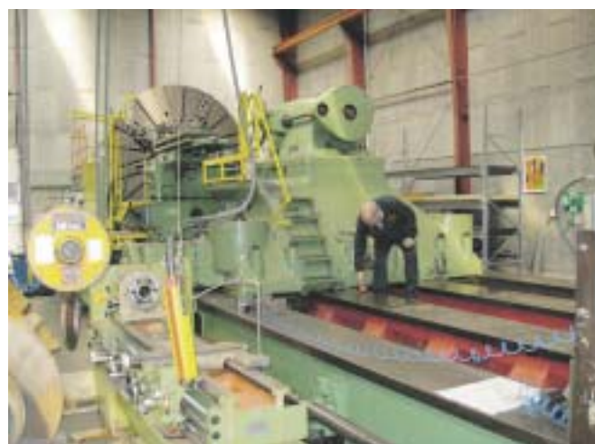
- Lykkegaards omfangsrige maskinpark tæller bl.a. en af Skandinaviens største drejebænke, som oprindeligt stod på B&W. Drejebænken kan klare emner op til 100 tons, 4000 mm i diameter og 12000 mm imellem pinner.
