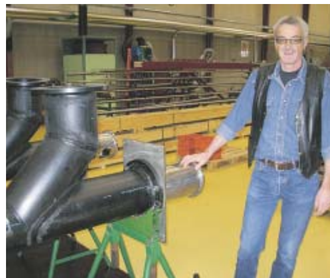
Som de første i branchen har Lykkegaard A/S udviklet en propelpumpe, hvor fremstillingsmaterialet er 100 % korrosionsbestandig. Pumpen fremstilles i et ualmindeligt stærkt og hårdført plastmateriale – PE-HD Polyethylen High Density. Det giver en næsten vedligeholdelsesfri pumpe med utrolig lang holdbarhed. Pumpens propel og aksel fremstilles typisk i rustfrit stål, hvorved man opnår den bedste kvalitet. PE-HD pumpen anvendes i aggressive medier som varmt havvand. Hvor de traditionelle pumper fremstillet i stål korroderer, er plastpumpen her den optimale løsning. - Vores PE-HD propelpumper fungerer bl.a. som fødepumper, cirkulationspumper og returpumper. Bl.a. fungerer plastpumpen som cirkulationspumpe på sydamerikanske havdambrug, hvor vandet ofte er over 25°C, forklarer Karsten Lykkegaard.
