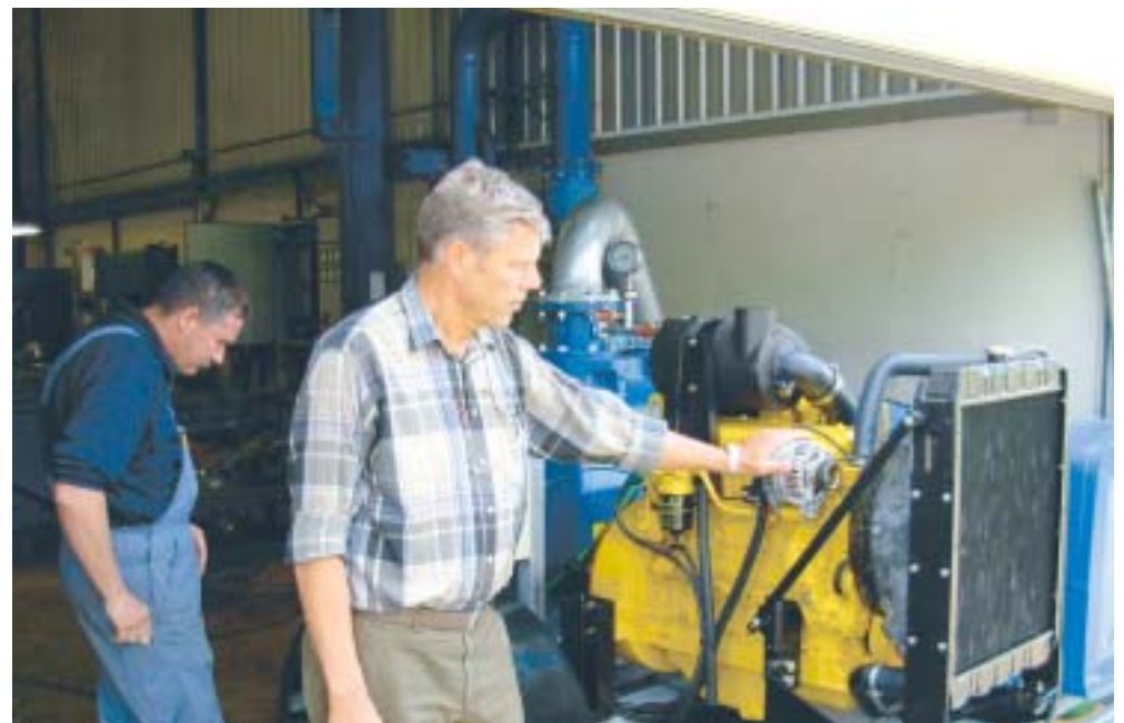
Med den nye Ultra-V kan der nu tilbydes selvansugende og tørtopstillede Gorman Rupp pumper til endnu mere krævende opgaver. – Det har bl.a. betydning i forbindelse med at opnå et bedre beredskab ved de ekstreme vandmængder, vi oplever oftere og oftere, siger Knud Abel, der her kaster et sidste blik på den mobile pumpestation, som klargøres til Hedensted-udstillingen
