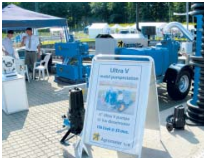
På Agrometer's stand ved årsmødet i Hedensted kunne ses en mobil pumpestation, hvor Ultra V pumpe er sammenbygget med en 61 kW dieselmotor
