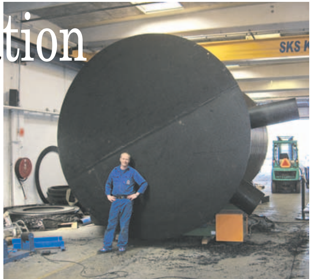
Her ses en af brøndene, som er anvendt ved SEB-projektet. Billedet er taget på KWH Pipe's fabrik i Svinninge, og personen på billedet medvirker til at give en opfattelse af, hvor store størrelser, der kan arbejdes med
