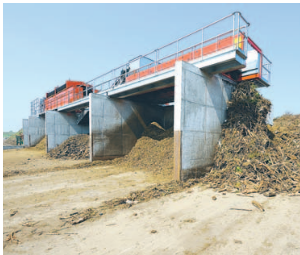
KomTeks nye maskine koster 6.000.000 kroner og sorterer i 7 fraktioner: plast, stenjern og 3 størrelser gren/kompost. Den normale kapacitet er 200 ton/time. Maskinen sparer 70% på energiomkostningerne i forhold til de maskiner, KomTek tidligere brugte til opgaven
