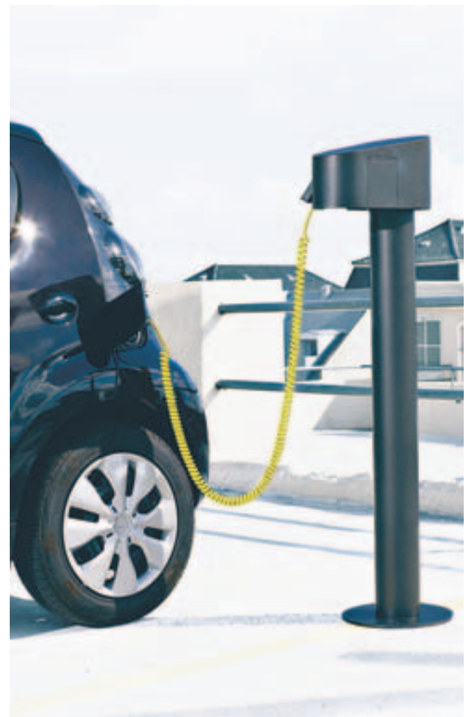
Opladning: 15-85% = 5 timer, 15-95% = 5,4 timer, 100% = 6 timer. Bilens stik sættes til et 220 volt stik (13 amp.), så lader den op. En almindelig kontakt kan bruges.
