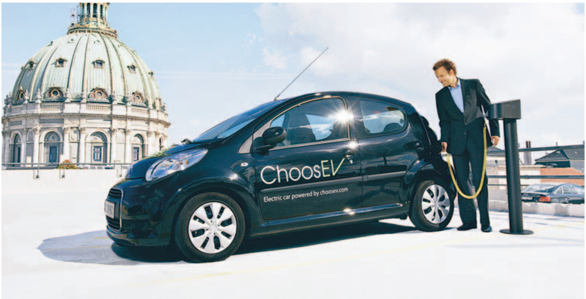
Citroen C1 EV'ie kan på en fuld opladning køre 80-100 km. Det dækker behovet for 87% af hele den europæiske befolkning, som gennemsnitligt kører under 60 kilometer om dagen. Topfart er ca. 100 km/t. Motoren yder AC 30 kW/51 HK
