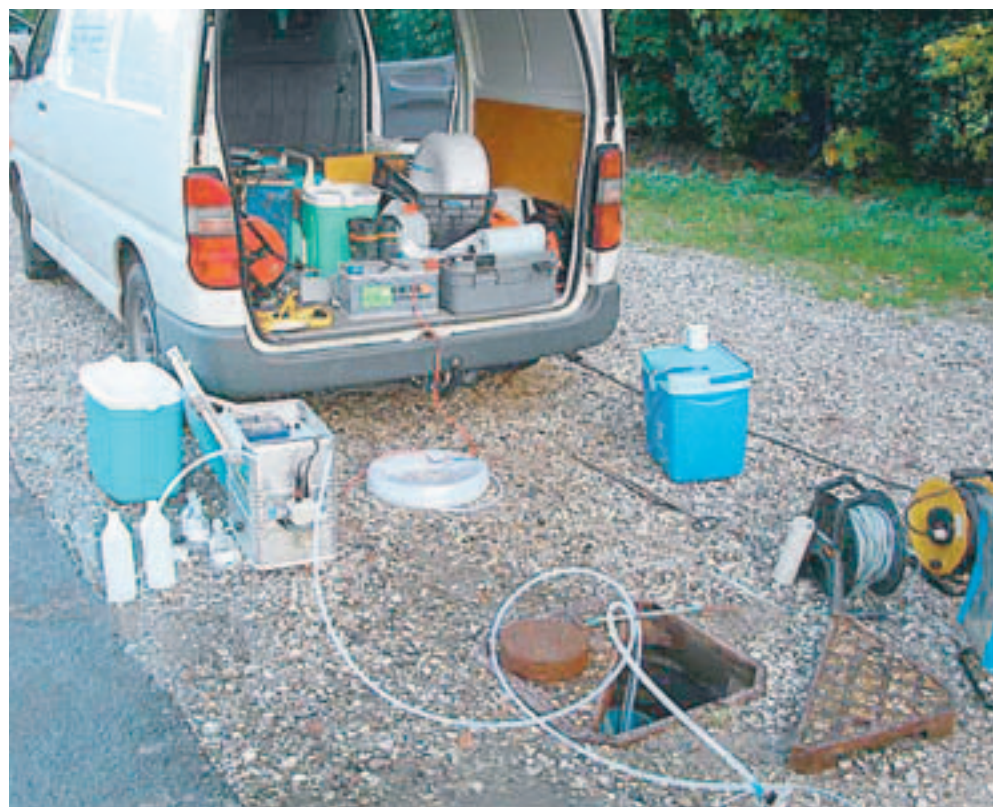
Vandprøvetagning ved monitoringsboring
