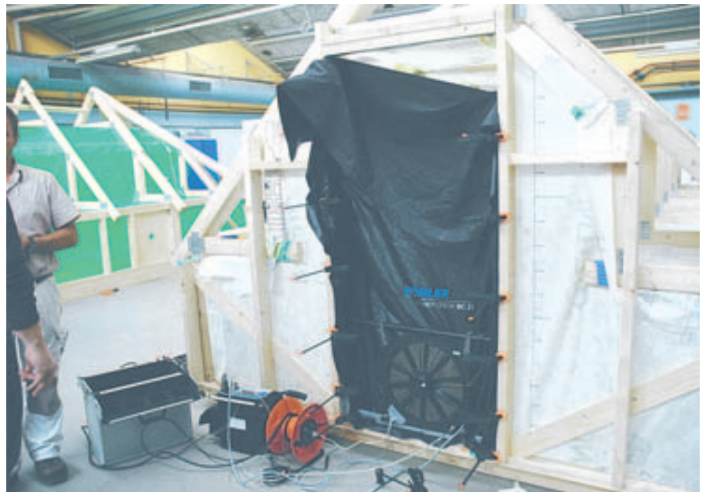
Blowerdoor teknikken afdækker bygningernes tæthed. Billedet viser en undervisningsopstilling på Erhvervsakademiet Nordsjælland
